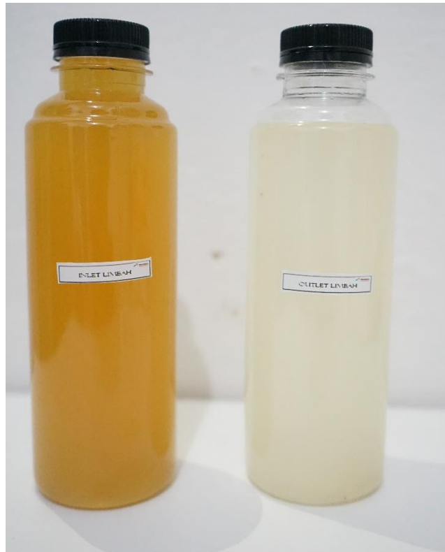
Gambar 6.. Perbandingan Warna Limbah Sebelum (kiri) dan Setelah (kanan) Masuk IPAL
