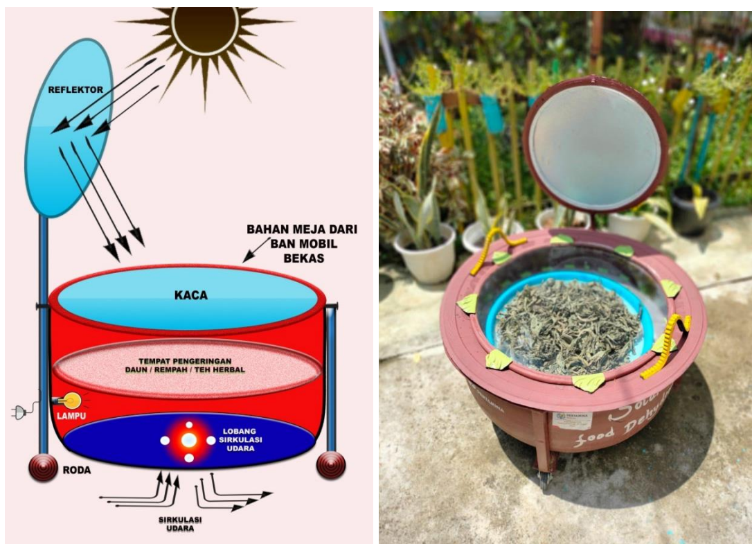
Gambar 3. Desain alat dan Dehidrator yang telah dirangkai oleh Local Hero binaan Pertamina RU III Plaju
