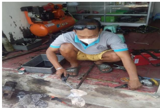
Gambar 9. Kegiatan perbaikan baling-baling perahu nelayan Tanjung Mas oleh mekanik bengkel
